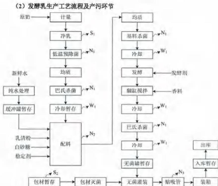
图2 发酵乳工艺流程及产污环节图
